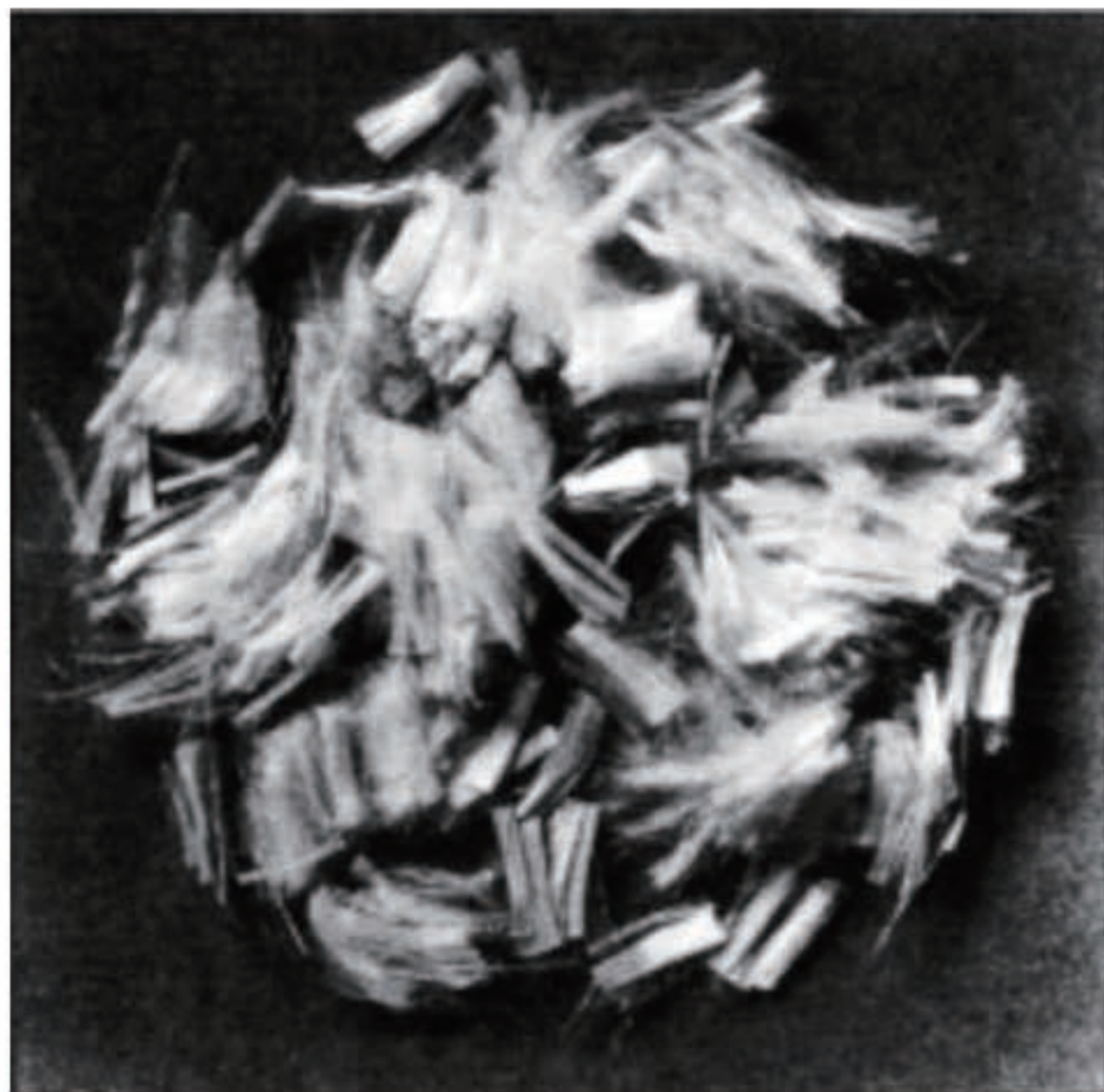
图3.4. KEVLAR® 短纤维照片
